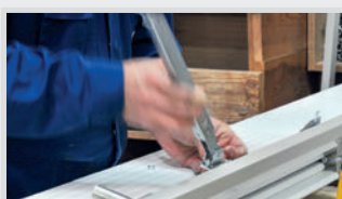
PRÉMONTAGE EN ATELIER des tapées cornières et accessoires
